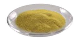
聚氯化铝是—种新型无机高分子净水剂。它是介于三氯化铝和氢氧化铝之间的水解产物,有较强的架桥吸附性能,易溶于水,水解过程伴随电化学凝聚、吸附和沉淀等物理化学过程,净水效果远优于传统的低分子净水剂硫化铝、三氯化铁、硫酸亚铁和明矾等。在国内外广泛用于饮用水、工业用水的净化和污水处理,受到用户的欢迎和重视。
